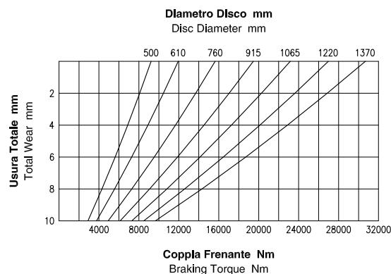
**Attenzione:** La coppia iniziale può essere inferiore dal 30% al 50% rispetto al valore nominale. **Warning:** The initial braking torque can be from 30% to 50% lower than the nominal value.
