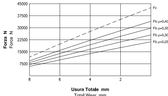
**Attenzione: La coppia iniziale può essere inferiore dal 30% al 50% rispetto al valore nominale.** Warning: The initial braking torque can be from 30% to 50% lower than the nominal value.
