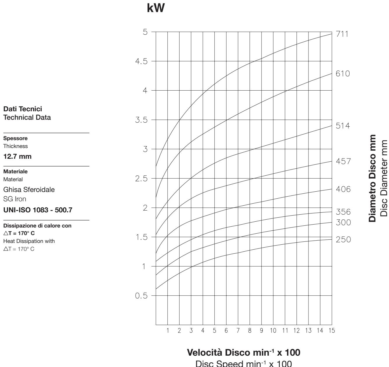
● Capacità termica - Frenata in continuo
