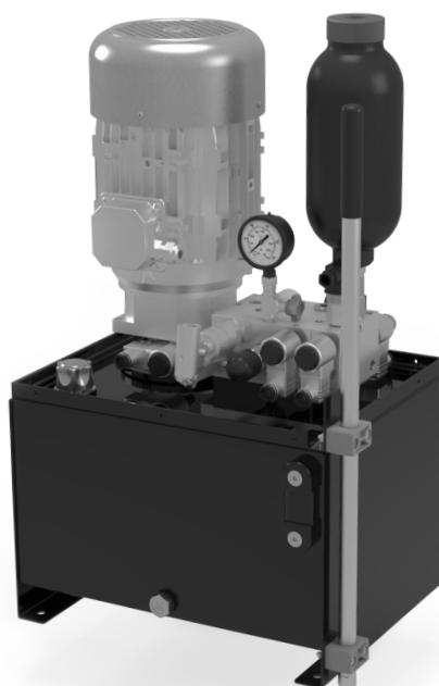
Le centraline idrauliche Coremo sono state progettate per completare e ottimizzare il sistema di frenatura, rendendolo sicuro ed in accordo con gli standard richiesti dall'applicazione. Tutte le centraline idrauliche possiedono una doppia valvola di sicurezza, un indicatore di livello/temperatura dell'olio, ed una pompa manuale utilizzabile in caso di mancanza di alimentazione elettrica. Le unità idrauliche sono disponibili sia per freni positivi che per freni negativi.
