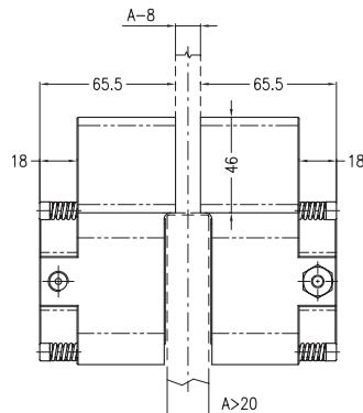
(\*) Per uso con dischi spessore maggiore di 20 mm le due pinze possono essere montate usando una piastra centrale di spessore = sp. disco - 8 mm.
