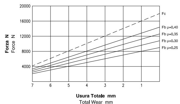
**NOTA:** Il grafico riporta l'andamento della forza tangenziale al variare del coefficiente di attrito. **NOTE:** The diagram shows the braking force performance with different friction coefficients.
