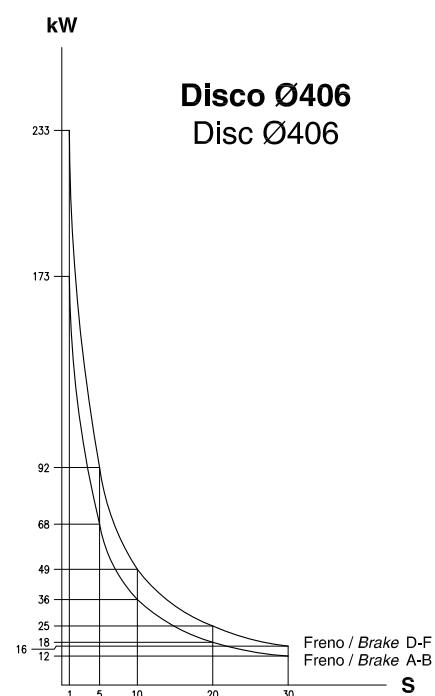
● Capacità termica - Frenata di emergenza
